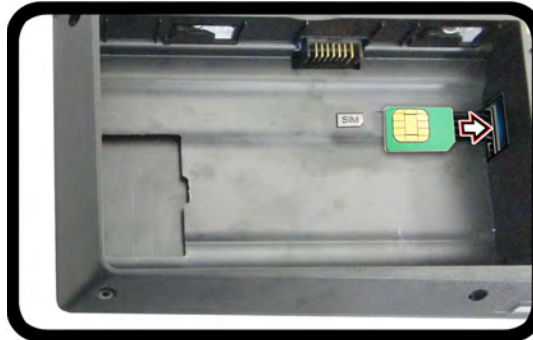
Abb. 34 - Herausnehmen des Akkus und einsetzen der USIM-Karte
